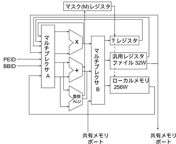
Figure 6: PE の論理的構造
